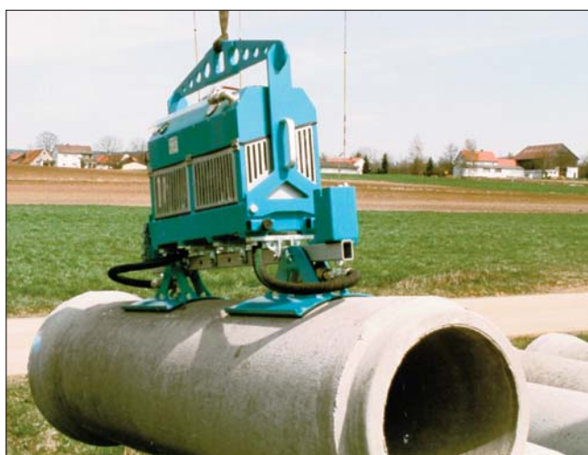
Kappa Levator avec moteur de combustion, cadre porteur avec 2 plaques aspirantes spéciales pour tuyaux d'un diamètre intérieur de 500 mm, capacité de charge 1.000 kg.
